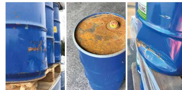
Leichter Flugrost und leichte Beschädigung: kein Ausscheidungsgrund!
